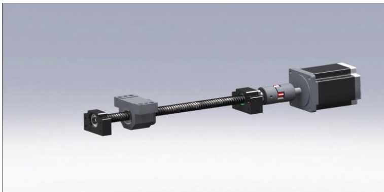
Рисунок 1. Модель механизма перемещения форточки в теплице на шаговом двигателе ДШИ-200-1
