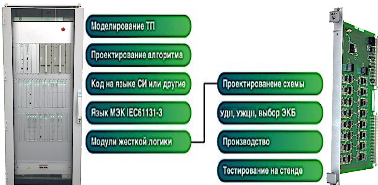
Рисунок 3. Общий вид шкафа КСА, порядок создания и модуль НПЛ
