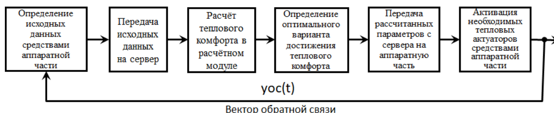
Рисунок 3. Последовательность определения теплового комфорта пользователей
