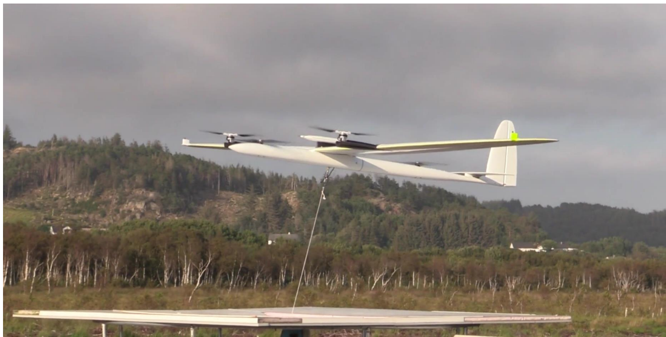
Рисунок 2. Летающий ветрогенератор Kitemill [6]
