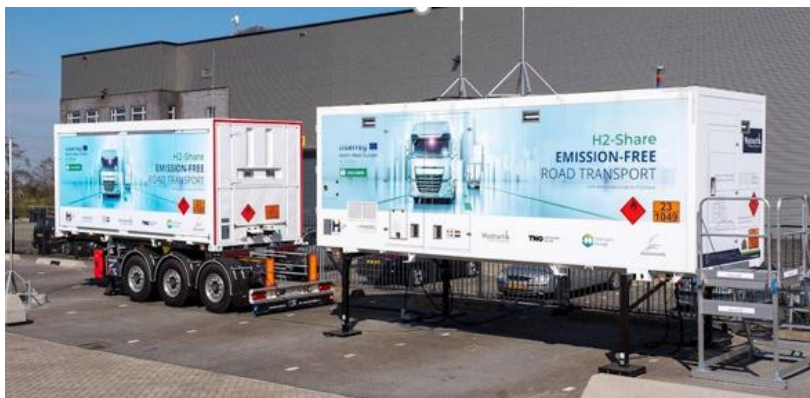
Рис. 2 - Мобильная водородная заправочная станция
