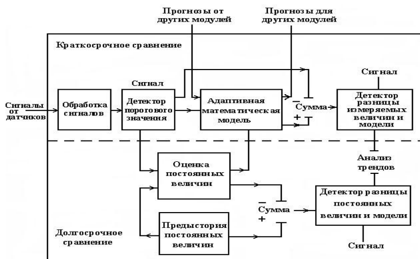
Рис.2 - Структурная схема модуля с математической моделью
