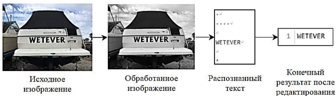
Рис. 4 – Распознавание символов на снимке судна
