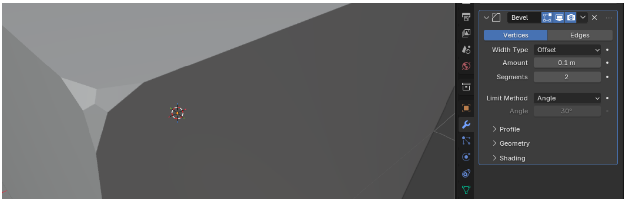
Рисунок 188. Создание скругления на углах объекта, значение 2
