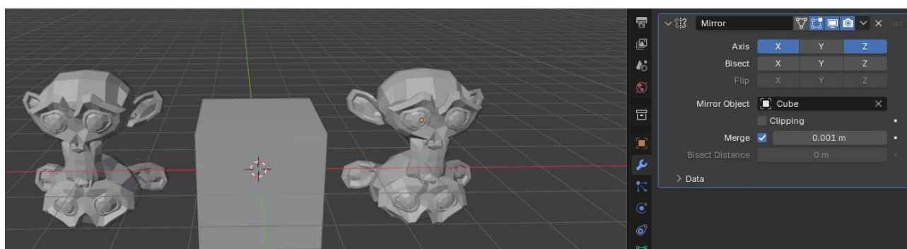
Рисунок 223. Создание зеркального объекта по осям OX и OZ
