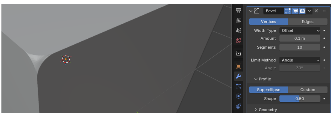
Рисунок 196. Тип формы, используемый для построения участков с фаской на углах объекта, форма профиля круг 0,5
