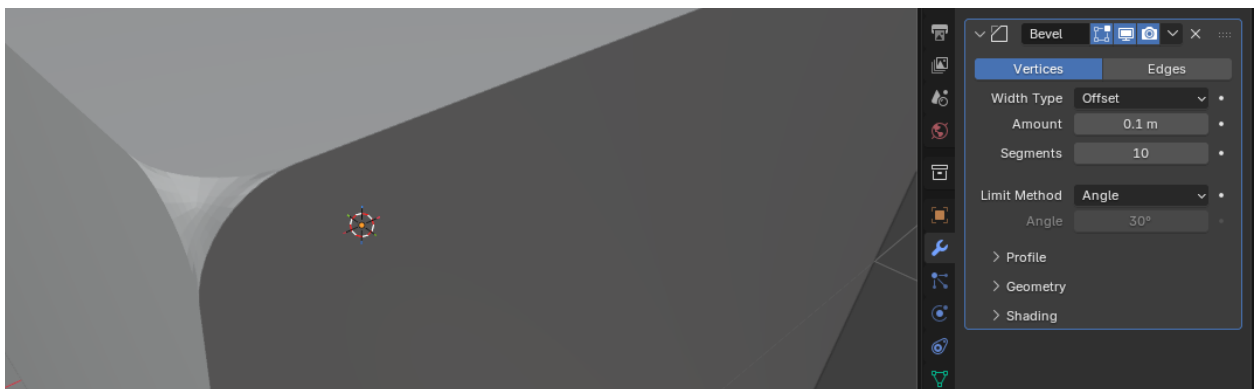
Рисунок 190. Создание скругления на углах объекта, значение 10
