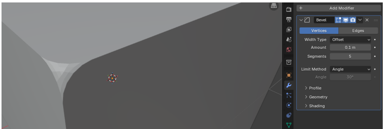
Рисунок 189. Создание скругления на углах объекта, значение 5
