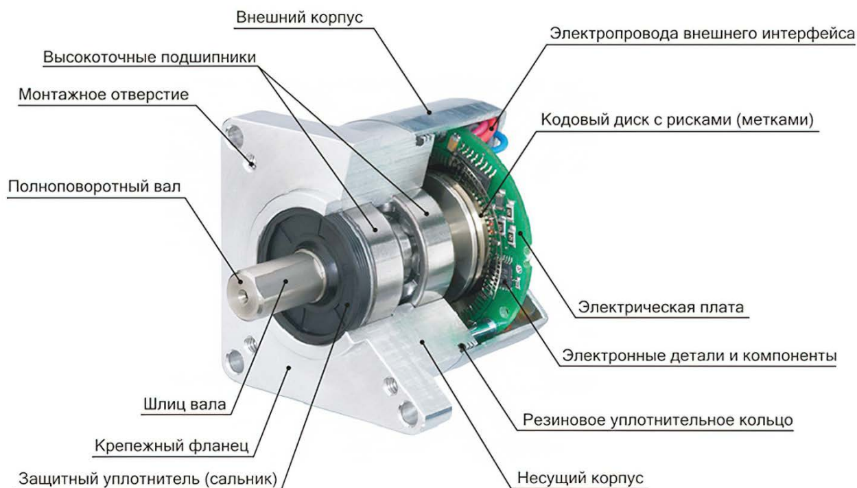
Рисунок 5.5. Устройство инкрементального энкодера
