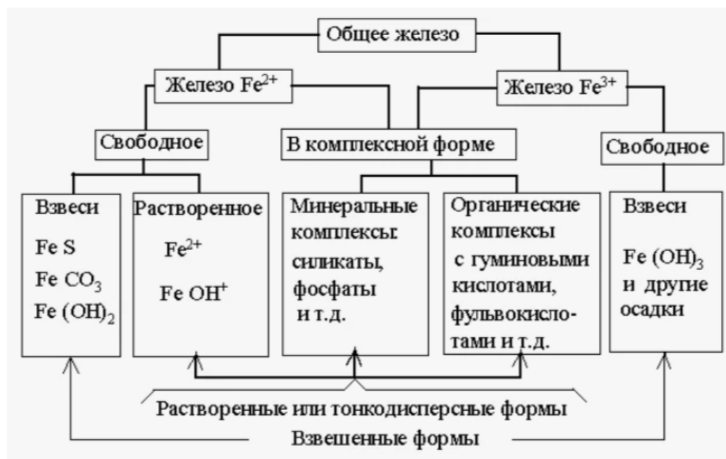
Рисунок 36. Разнообразие форм соединений железа в воде
