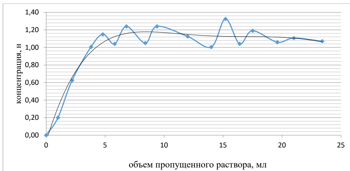
Рисунок 1. Кривая адсорбции отработанной серной кислоты
