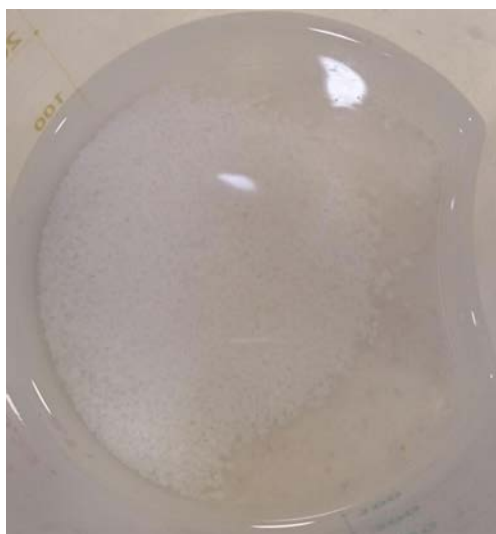
Рисунок 2. Белый осадок акрилатов после высаливания \text{Al}_2(\text{SO}_4)_3
