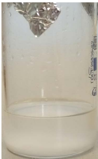
Рисунок 4. Расслаивание при обезвоживании K_2CO_3 : верхний слой – концентрированный спирт
