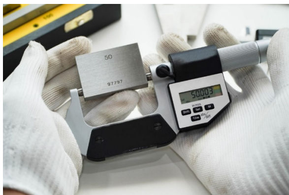
Рисунок 4.1. Проверка точности приборов при помощи КМД
