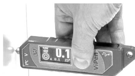
Рис.3.12. Измерение вибрации виброметром
