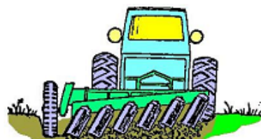
Плуг на роликовом ходу. Вместо скользящих пластин плуг имеет ролики. Таким плугом можно пахать вдвое быстрее.
