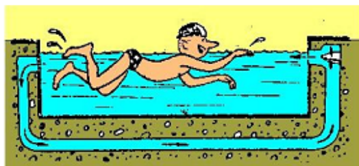
Устройство для тренировки пловцов. Пловец остается на месте, движется вода.
