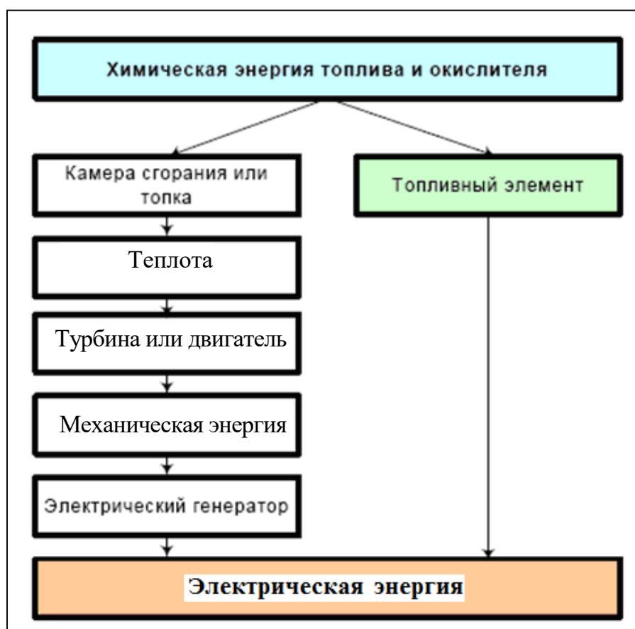
Рисунок 3.14 – Ступени преобразования химической энергии традиционным и электрохимическим способами
