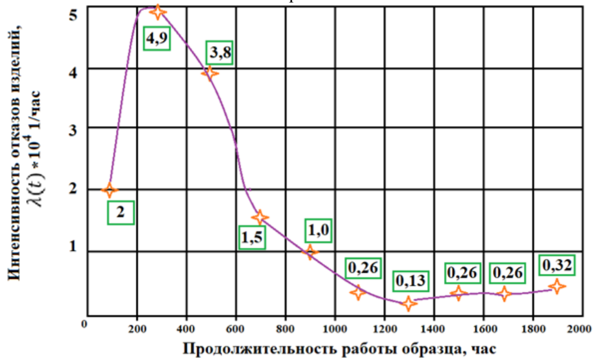
Рисунок 2.4. Зависимость интенсивности отказов изделия от наработки
