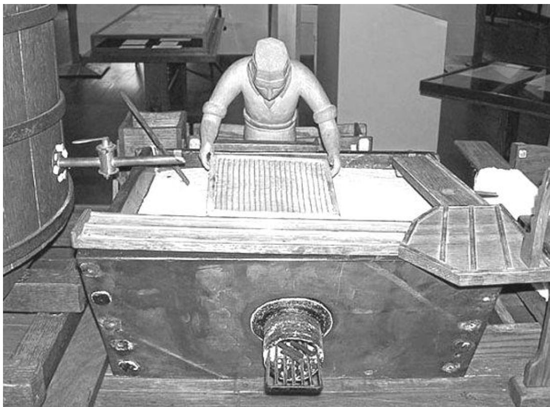
Рис.38. Процесс формирования бумаги вручную ( макет)
