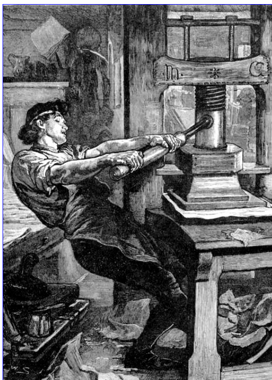
Рис.36. Получение оттиска на печатном станке
