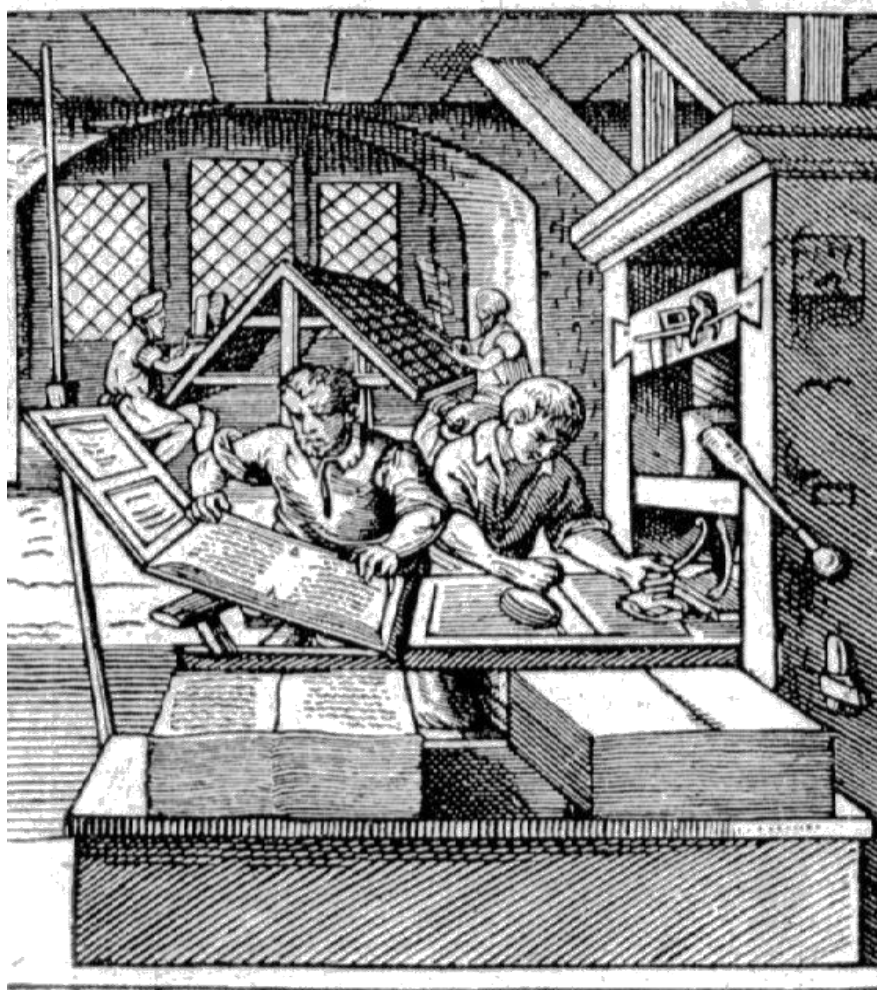
Рис.35 .Усовершенствованный печатный станок Гутенберга в развернутом виде ( гравюра Аммана 1568 г.)
