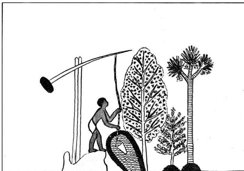
Рис. 11. Шадуф для подъёма воды в Древнем Египте
