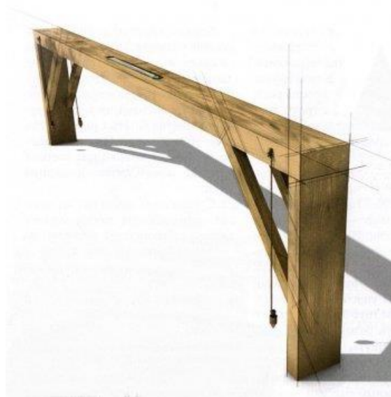
Рис.15. Хоробат - римский измерительный прибор со свинцовыми отвесами и водным уровнем для определения угла наклона и разницы высот
