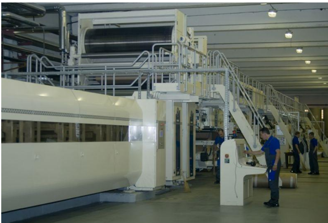
Рис.68. Гофроагрегат. Каменская бумажно-картоноделательная фабрика
