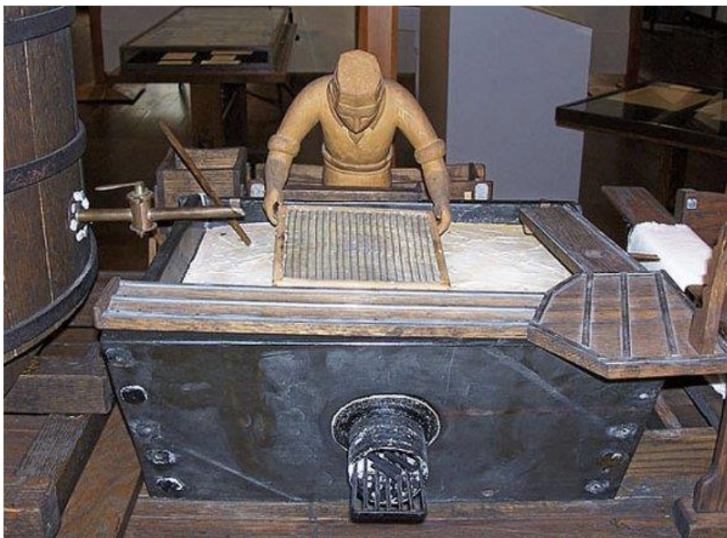
Рис.38. Процесс формирования бумаги вручную ( макет)
