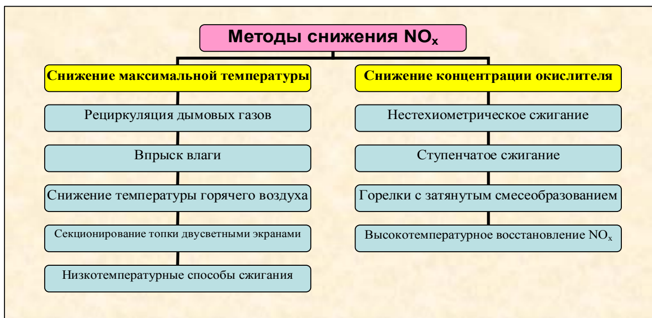
Рис. 39. Методы снижения выбросов оксидов азота
