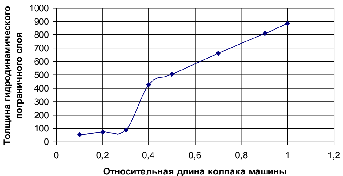
Рис. 2.2. Изменение толщины гидродинамического пограничного слоя по длине колпака машины
