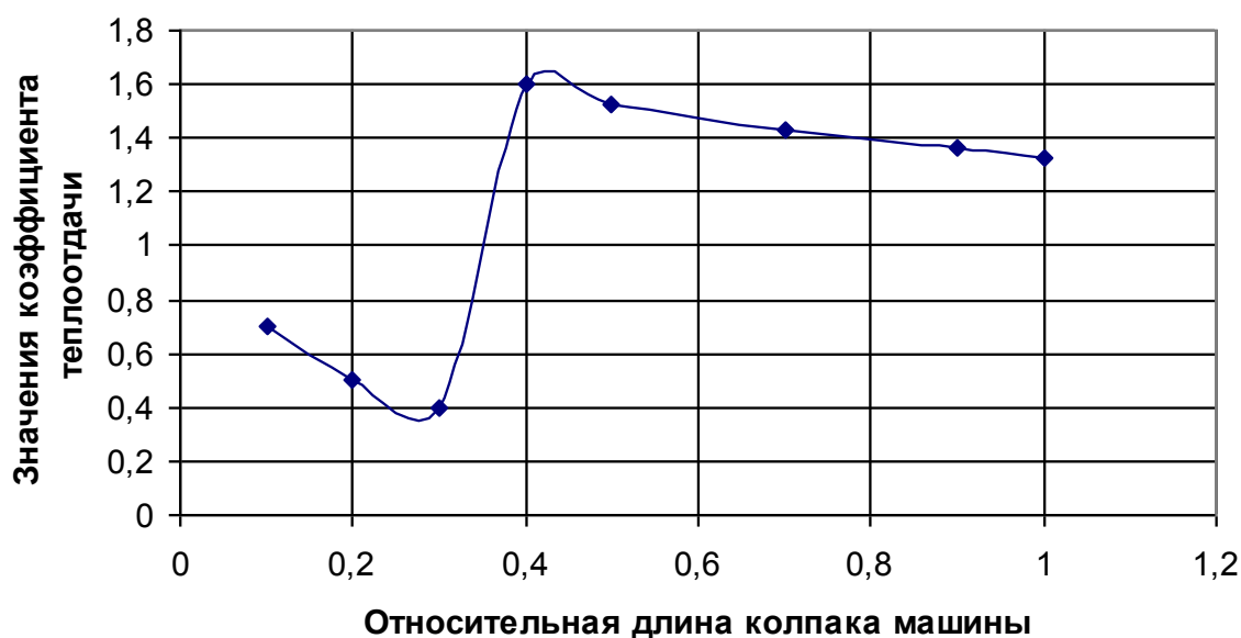
Рис. 2.3. Изменение коэффициента теплоотдачи по длине гидродинамического пограничного слоя
