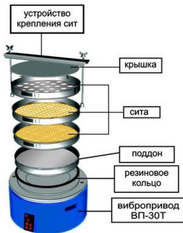
Рис. 10. Устройство для проведения ситового анализа угольной пыли
