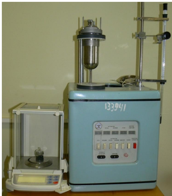
Рис. 4. Калориметр, бомба и весы с навеской топлива
