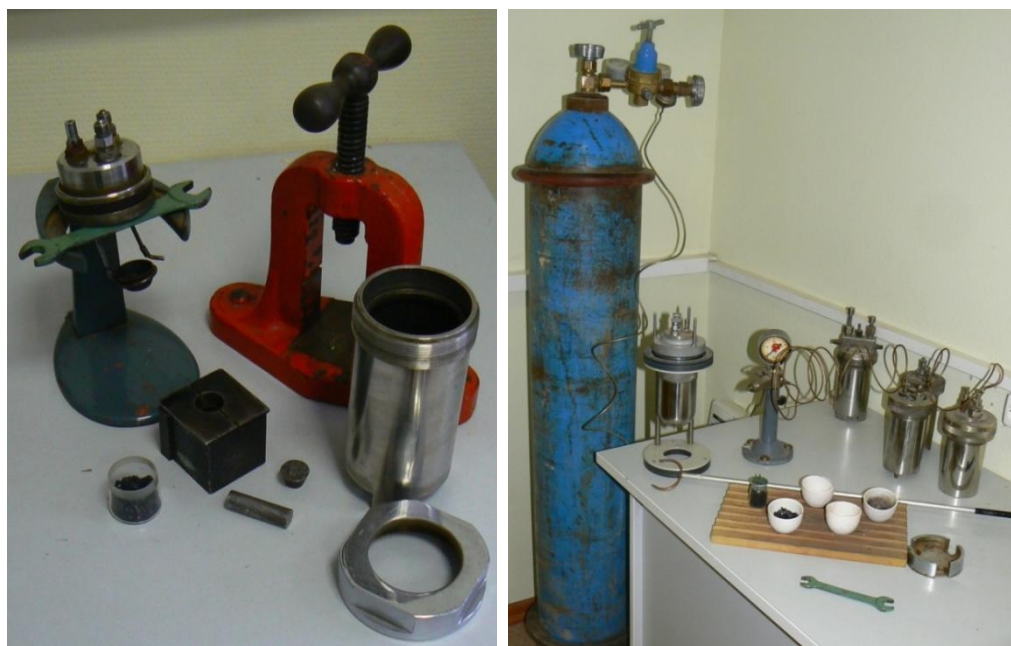
Рис. 6. Пресс для приготовления брикета топлива и баллон со сжатым кислородом
