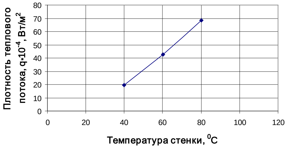
Рис. 6.8. Зависимость плотности теплового потока от температуры стенки
