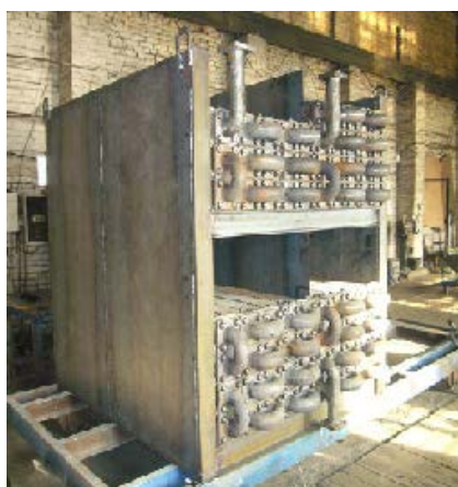
Рисунок 7.6 – Конструкция водяного экономайзера, применяемого в котлах низкого давления (до P = 2,4 МПа) и малой мощности
