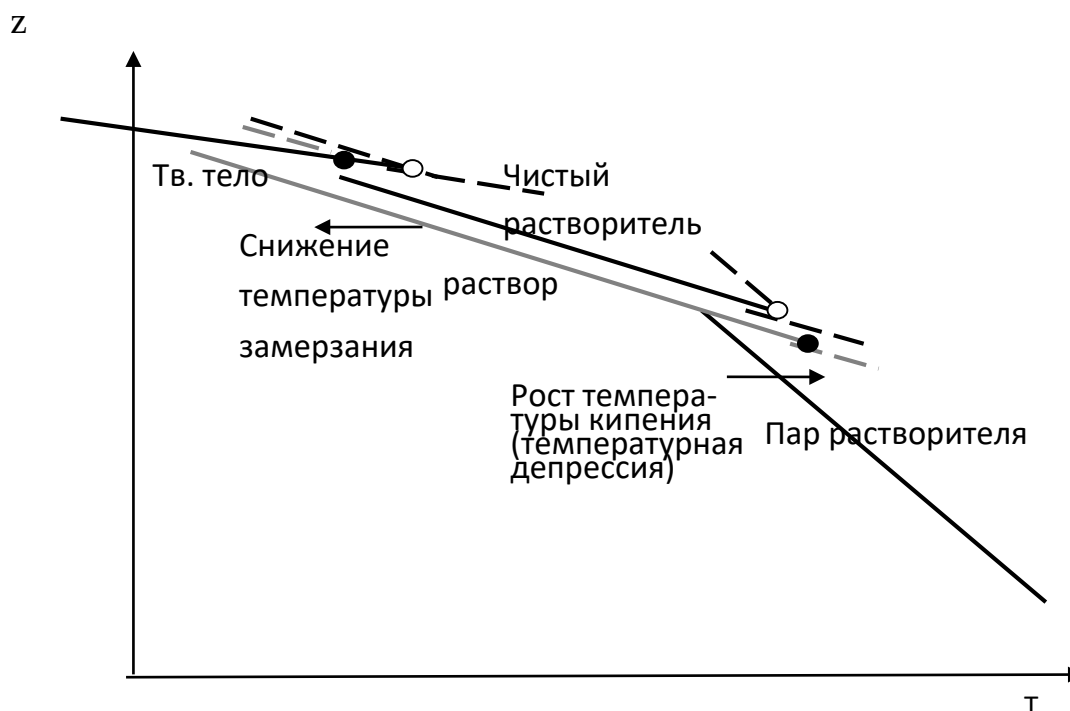
Рисунок 3.2 – Иллюстрация изменения химического потенциала при растворении и возникновении температурной депрессии
