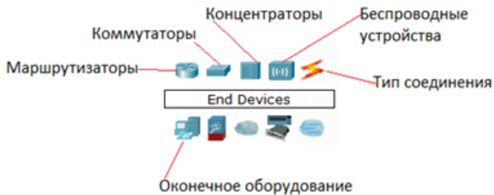
Рисунок 2 – Панель оборудования Packet Tracer (Основные типы оборудования)
