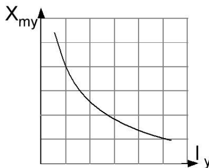
Рис.14. Кривая изменения индуктивного сопротивления МУ от тока управления
