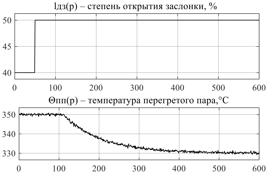
Рис. 61. Экспериментальная кривая зависимости температуры пара от степени открытия дроссельной поворотной заслонки
