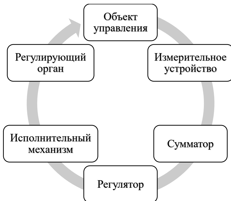
Рис. 15. Замкнутый контур автоматического управления
