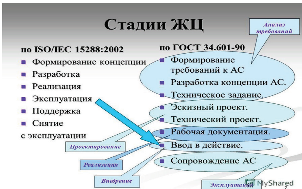
Рис. 2.1. Стадии жизненного цикла процесса проектирования АСУ [4].
