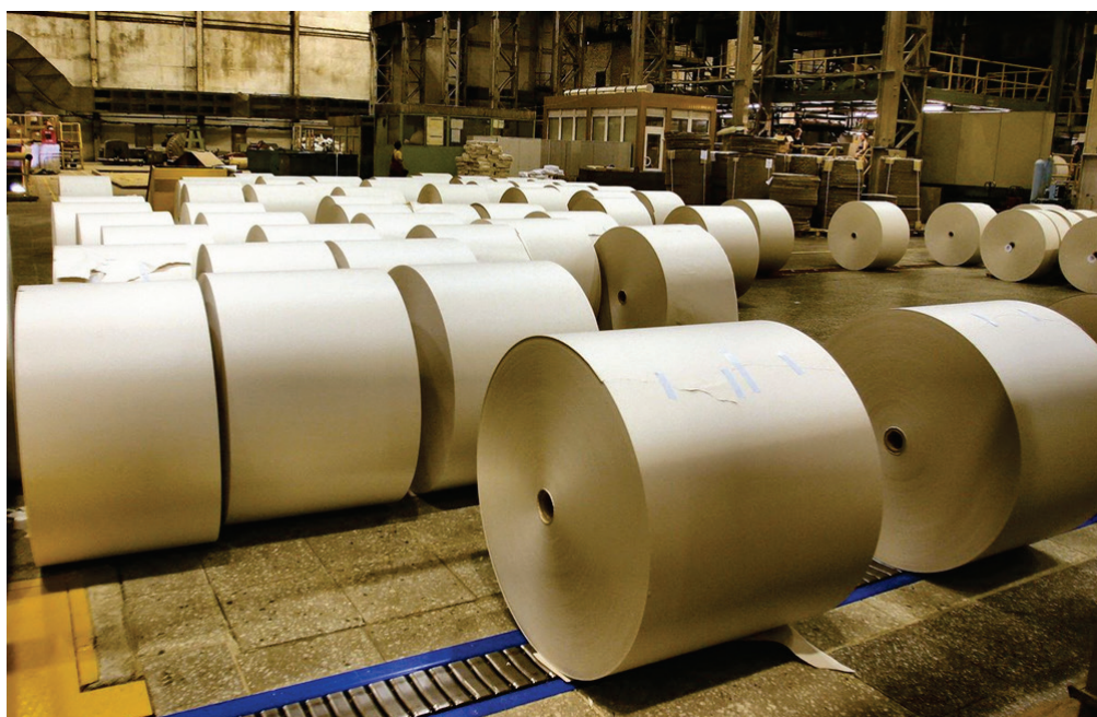
Рис. 3.7. Участок нарезки бумажного полотна и система транспортировки на склад готовой продукции
