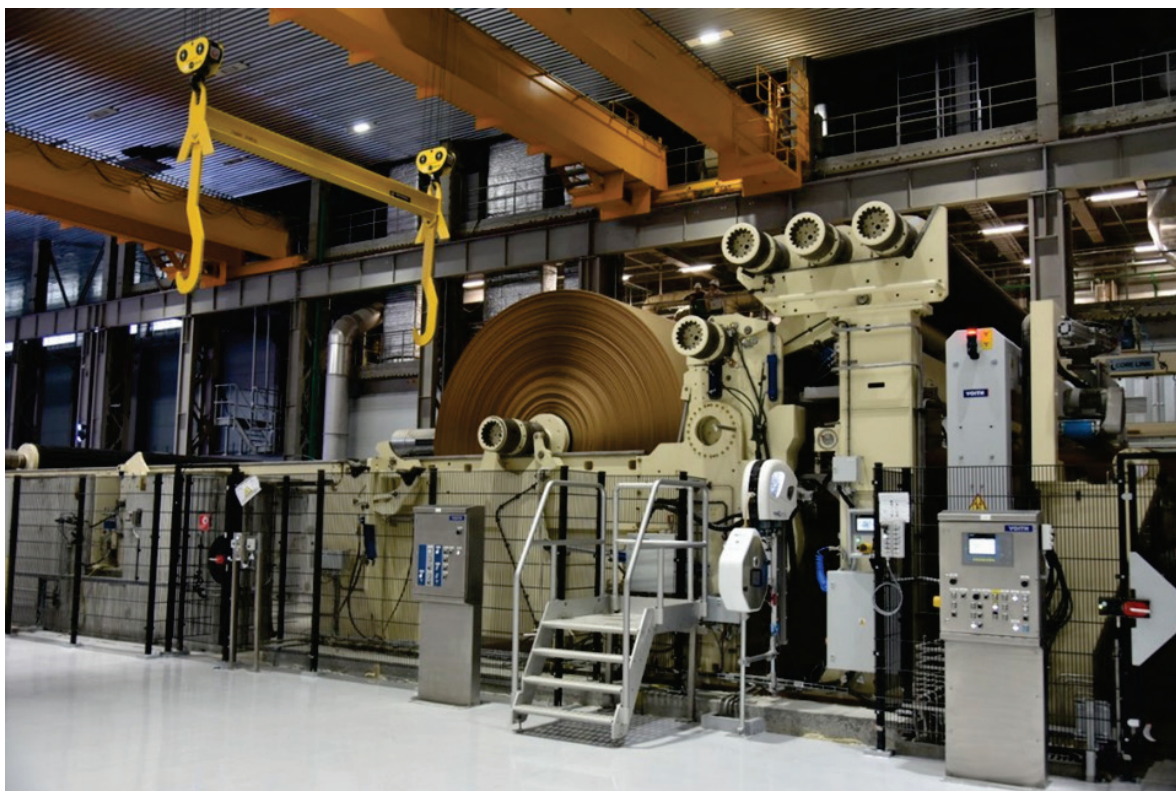
Рис. 3.6. Участок сбора готовой продукции и подготовки для дальнейшей нарезки и расфасовки бумажного полотна
