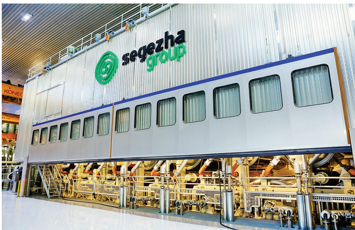
Рис. 3.5. Внешний вид БДМ-11. Участок по управлению процессом сушки бумажного полотна (сам диспетчерский пункт оператора находится за кадром)
