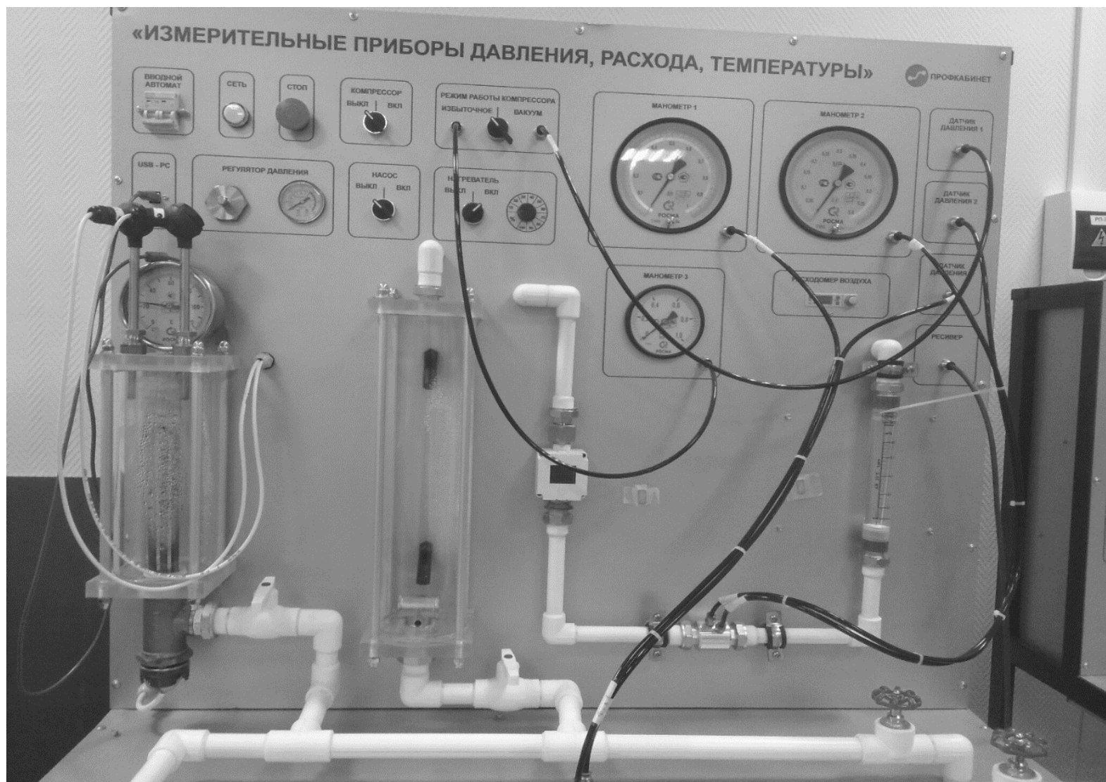
Рисунок П2.1 – Органы управления и средства отображения информации лабораторного стенда ДД-ИПД-011 (№ 2)
