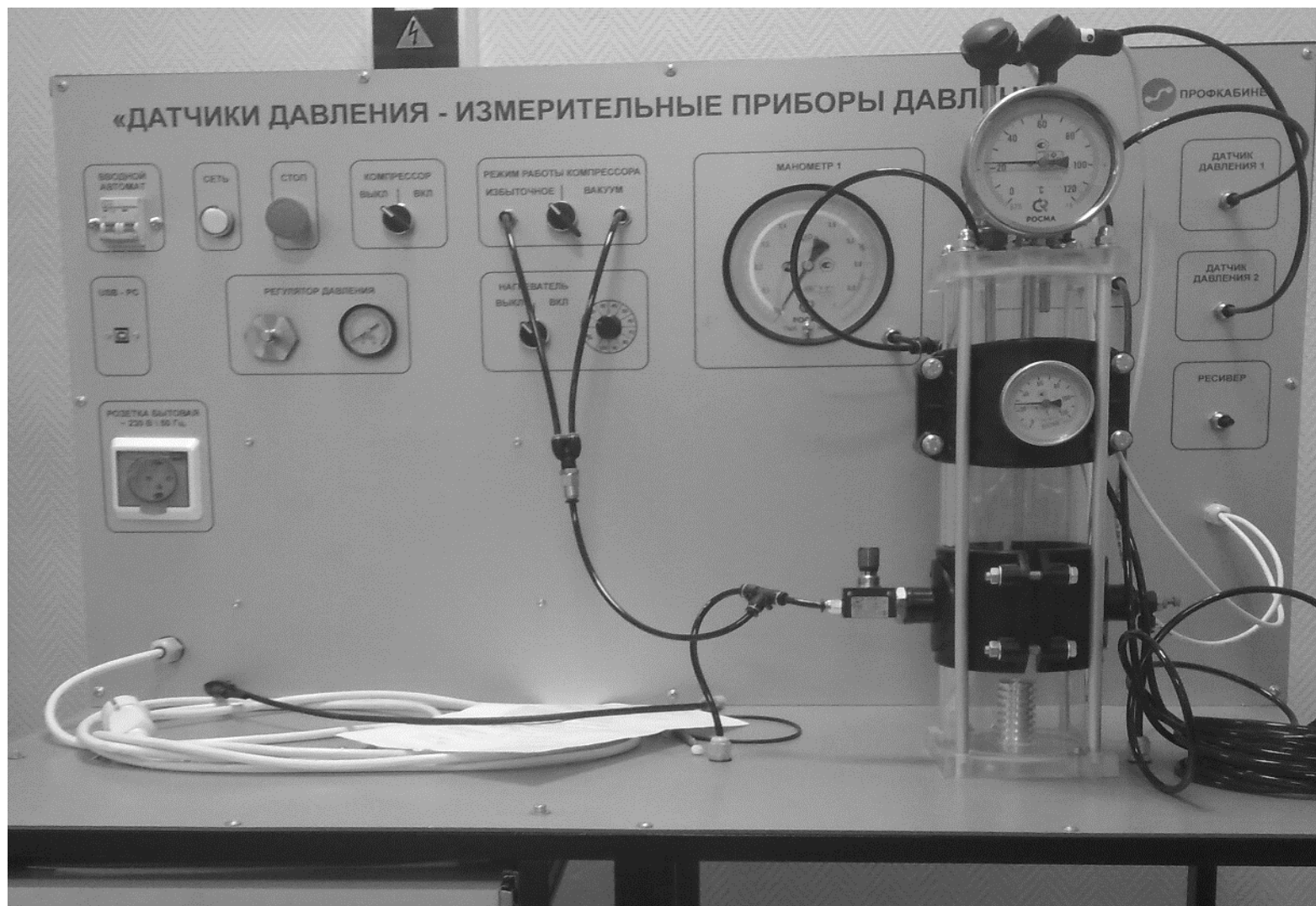
Рисунок П1.1 – Внешний вид лабораторного стенда ИПДРТ4 (№ 1) «Датчики давления»
