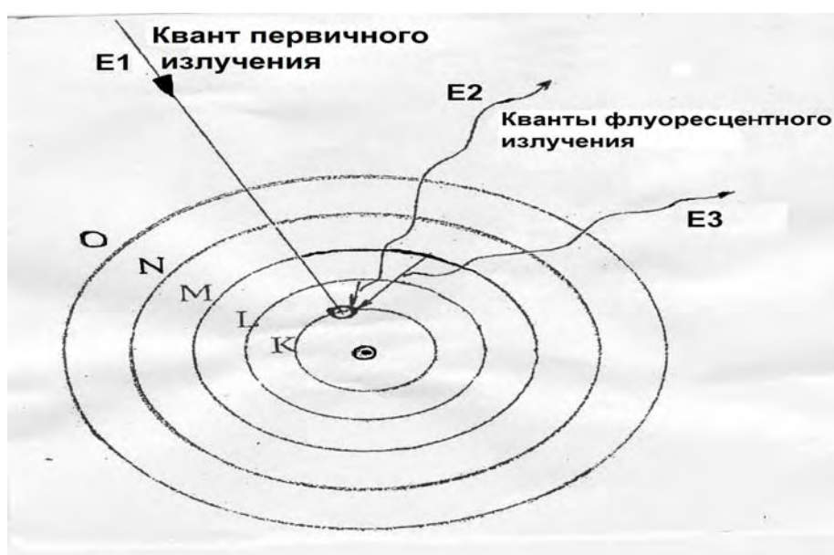
Рис. 1. Схема взаимодействия первичного излучения с атомом вещества
