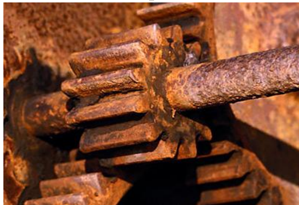
Рис. 4. Некоторые случаи газовой коррозии металлов в технологических средах.
