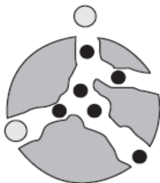
Рис. 19. Схематическое изображение процесса закрепления вещества в порах сорбента при гелепроникающей хроматографии
