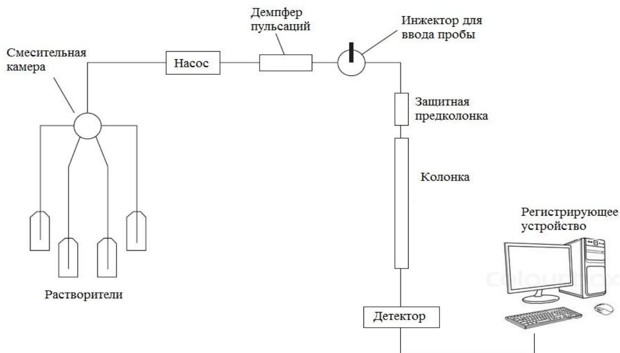
Рис. 18. Схема проведения высокоэффективной жидкостной хроматографии
