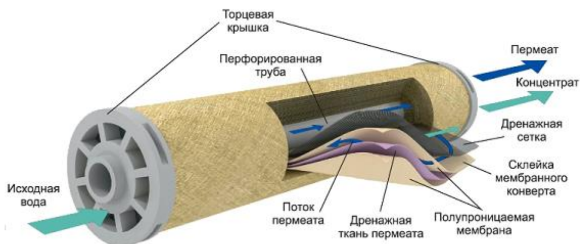
Рисунок 57. Строение обратноосмотического элемента в сборе
