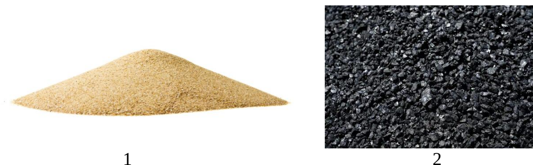
Рисунок 14. Наиболее распространенные фильтрующие материалы насыпных фильтров:
