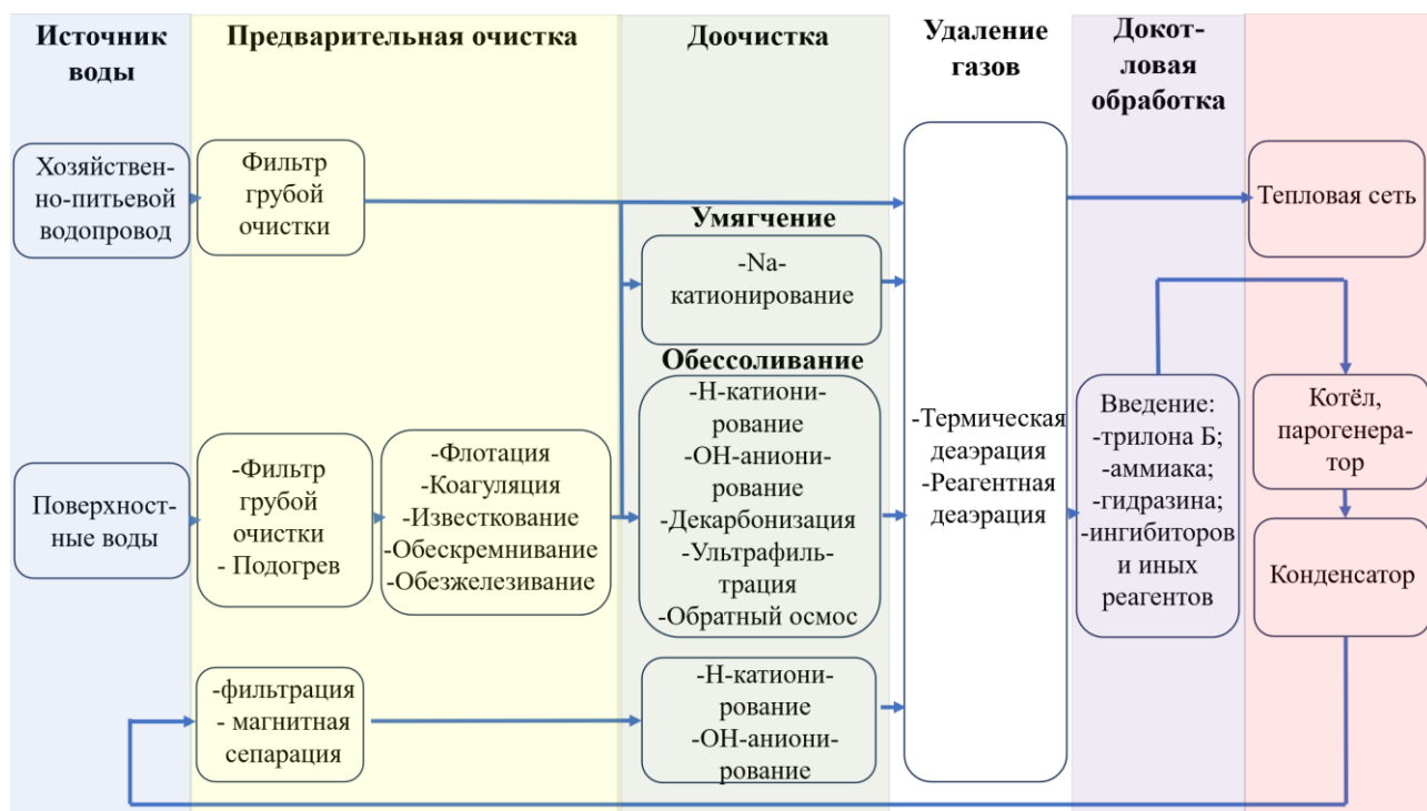
Рисунок 6. Принципиальная схема подготовки воды в теплоэнергетике
