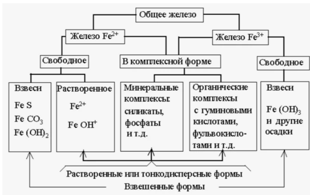
Рисунок 39. Разнообразие форм соединений железа в воде
