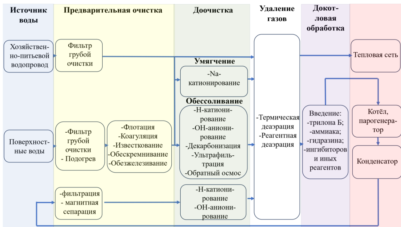
Рисунок 6. Принципиальная схема подготовки воды в теплоэнергетике
