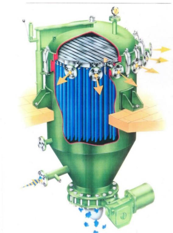
Рисунок 16. Устройство для фильтрования поверхностного типа
