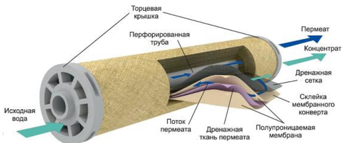
Рисунок 57. Строение обратноосмотического элемента в сборе
