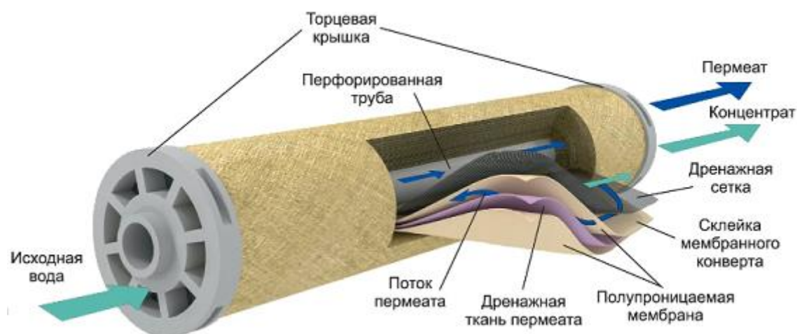
Рисунок 54. Строение обратноосмотического элемента в сборе
