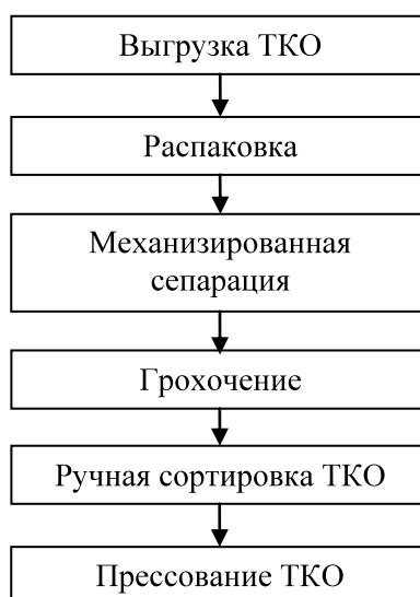
Рис. 3.1. Этапы обработки ТКО на МПС
