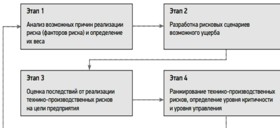
Рисунок – Процесс управления рисками на производстве
