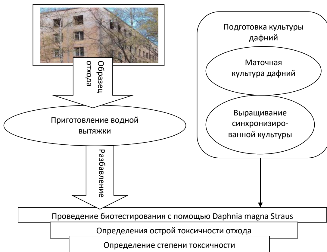
Рисунок – Блок-схема порядка определения токсичности на основании биотестирования
