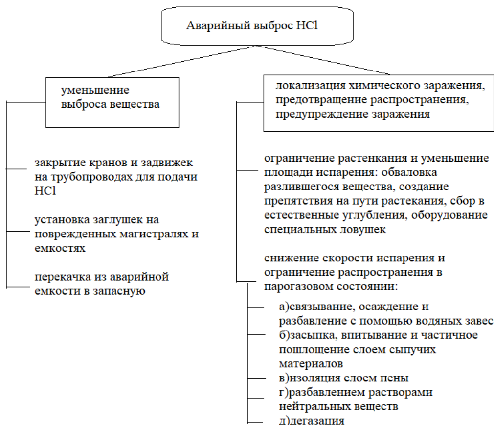
Рисунок – Мероприятия по ликвидации аварийного выброса HCl [4–6]
