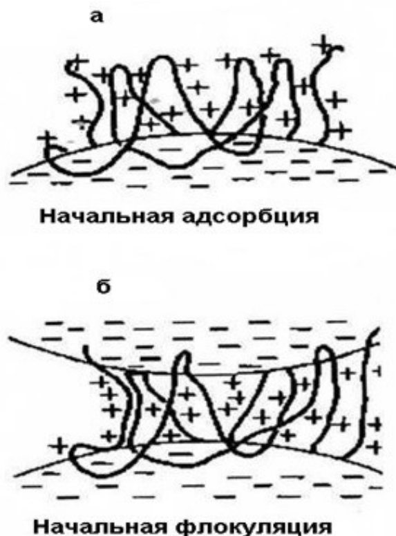
Рис.4. Схематичное представление флокуляционных превращений по модели образования мостиковой связи: а - положительно заряженные полиэлектролиты с высоким молекулярным весом частично адсорбируются на поверхности отрицательно заряженной частицы. Петли и хвосты, образуемые адсорбированной молекулой полимера, выходят в жидкую фазу; б - петли и хвосты адсорбированного полиэлектролита адсорбируются на другой частице, формируя «мостиковую связь» между двумя частицами
