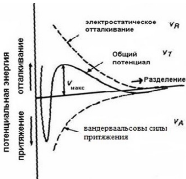
Рис. 2. Представления о взаимодействии энергии между частицами как о функции расстояния от распределения между двумя частицами. Рисунок иллюстрирует соотношение потенциальных энергий притяжения и отталкивания
