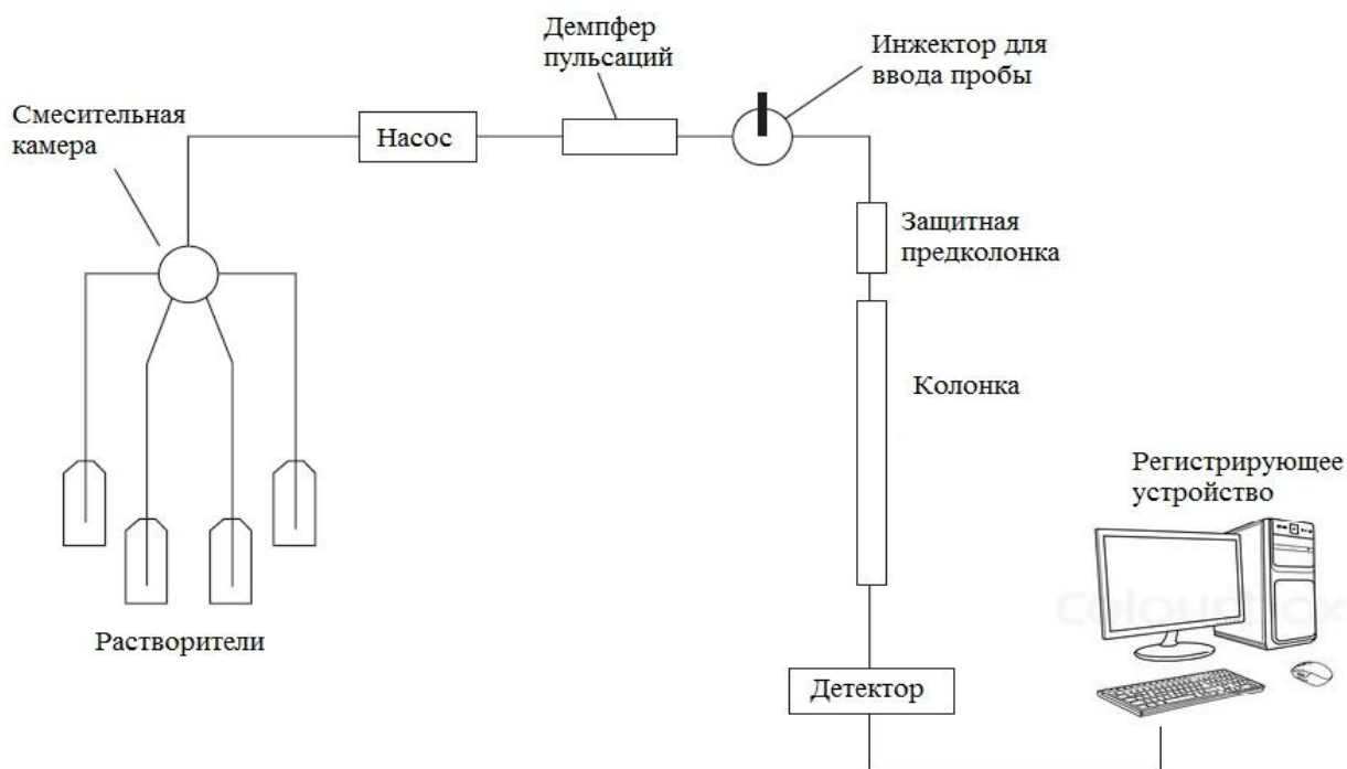
Рис. 18. Схема проведения высокоэффективной жидкостной хроматографии
