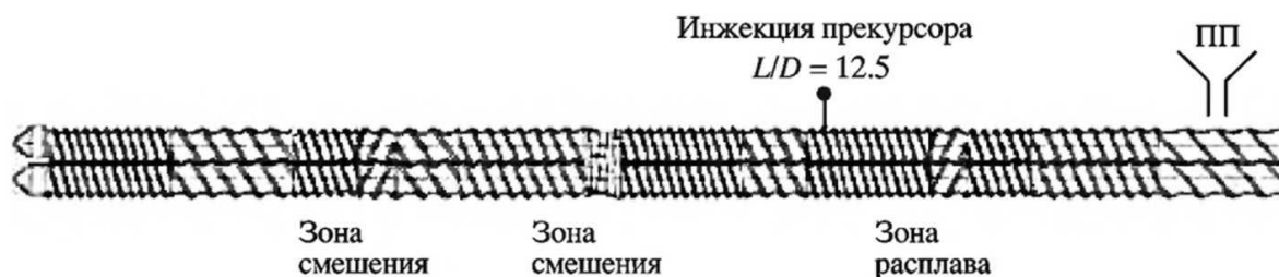
Рис. 39. Профиль шнека и точки локализации инъекции \text{Ti}(\text{OBu})_4
