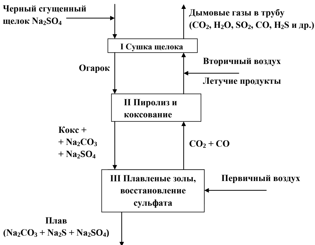
Рис. 9. Схема процессов, происходящих при сжигании сульфатного щелока
