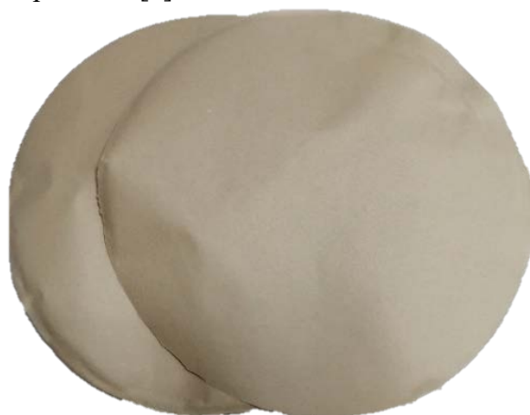
Рисунок 6 – Отливки из целлюлозы борщевика
