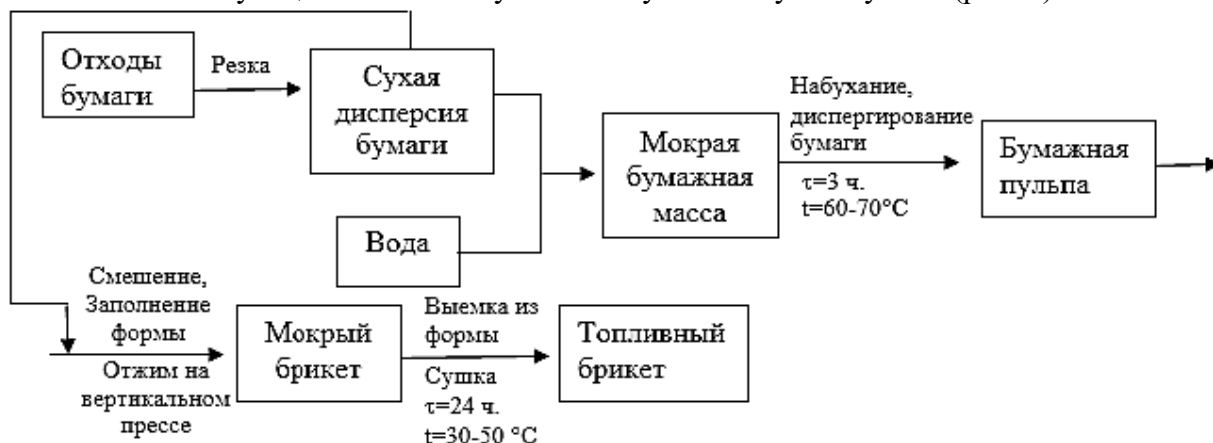
Рисунок 2 – Схема получения топливного брикета из бумажной пульпы и сухой резаной бумаги без использования связующего
