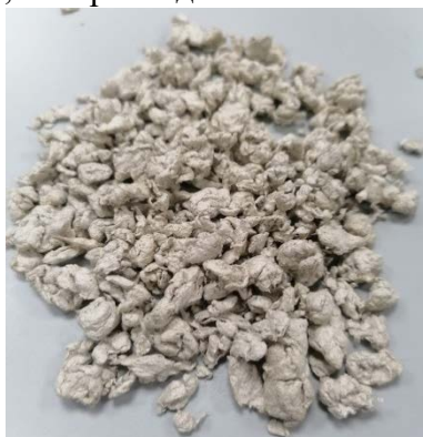
Рисунок 4 – Чистое волокно после промывки и отжима
