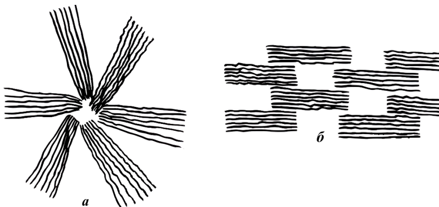
Рисунок 12 – Схематическое изображение надмолекулярных структур: а – сферолитной; б – фибриллярной
