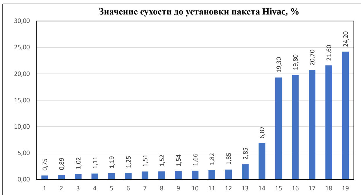
Рисунок 5 – Значение сухости бумажного полотна на обезвоживающих элементах, замеренное до установки пакета Нівас
