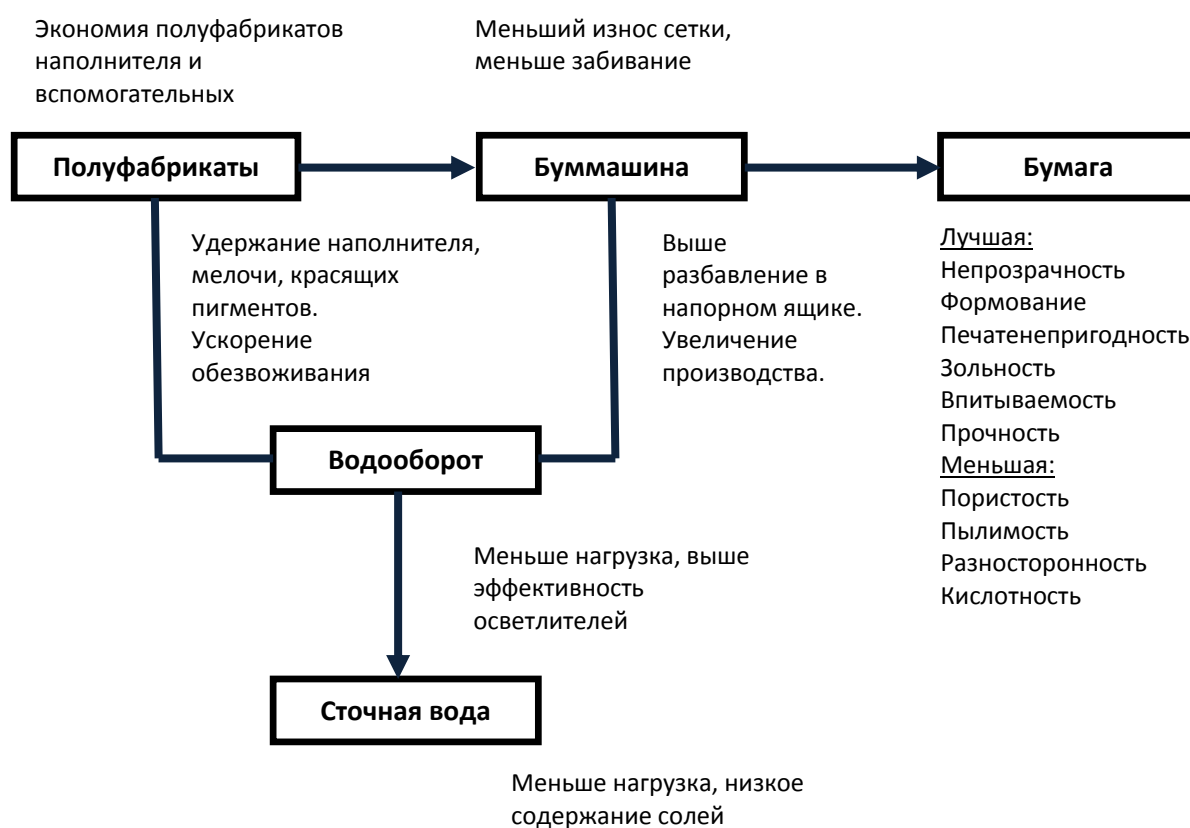
Рис. 8.2. Схема действия одного средства удержания
