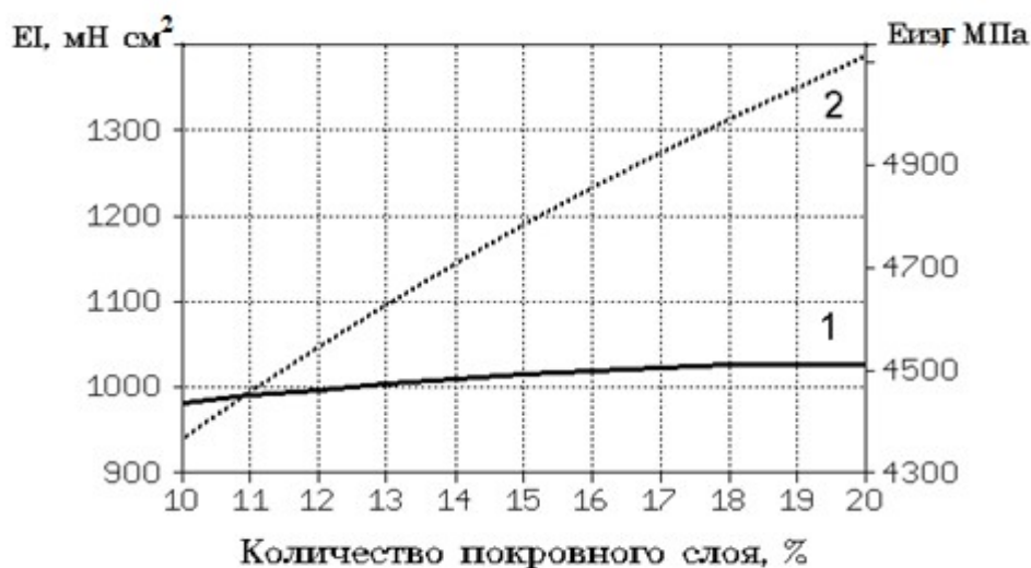
Рис. 5.27. Влияние доли покровного слоя крафт-лайнера на: 1 – жесткость при изгибе; 2 – модуль упругости при изгибе
