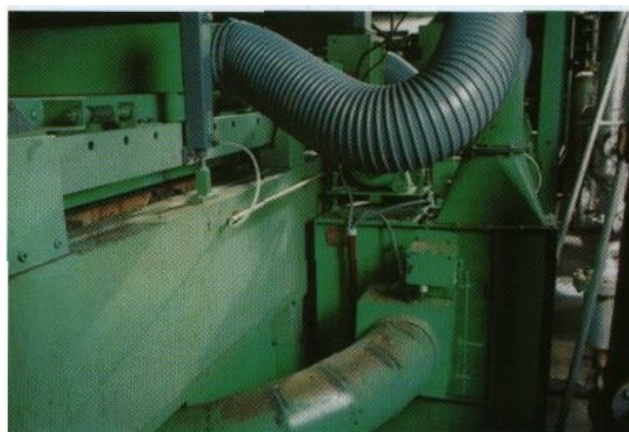
Рис. 4.8. Воздух уносится в неподвижные камеры нагревательной секции даблфейсера наподобие системы Langston ZCC
