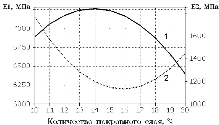
Рис. 5.26. Влияние доли покровного слоя крафт-лайнера на: 1 – модуль упругости; 2 – модуль в области предразрушения
