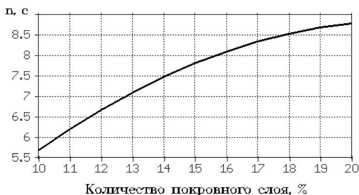
Рис. 5.28. Зависимость времени релаксации напряжений от доли покровного слоя крафт-лайнера
