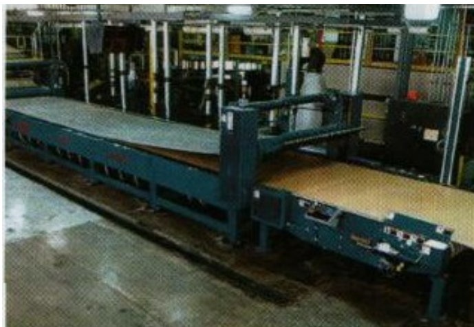
Рис. 4.10. В даблфейсере с меньшим количеством сукон фирмы Marquip загрузка осуществляется подъемом и опусканием стальных пластинок
