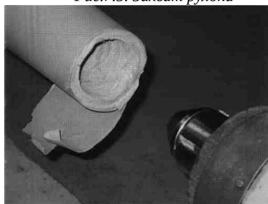
Рис.7.7. Изображение испорченной гильзы
