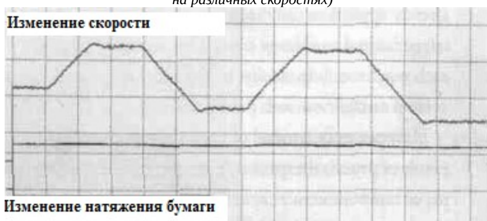
Рис.13.6. Натяжение бумаги на новом клеильном станке с цифровым управлением (нижняя кривая на графике показывает натяжение бумаги на различных скоростях)
