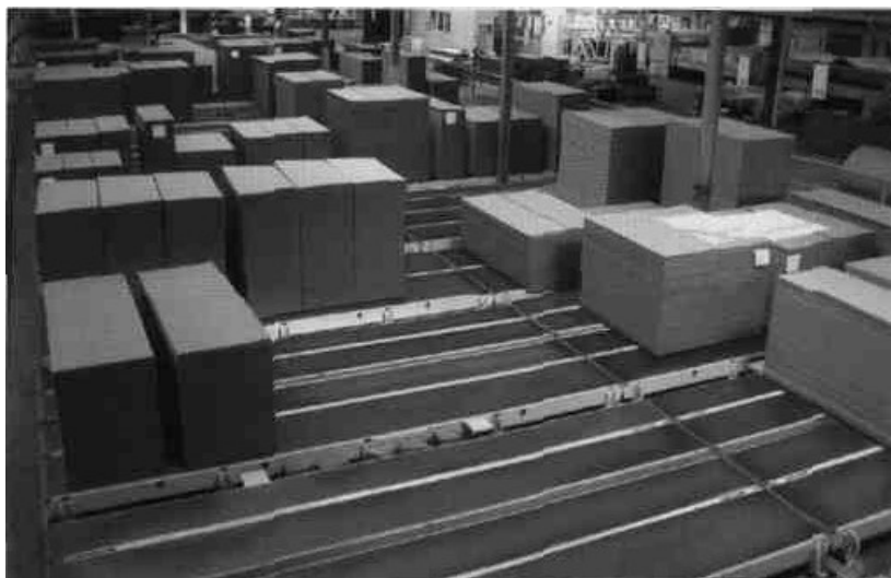
Рис.12.19. Конвейер с пластиковой цепью плавно транспортирует пакеты без какой-либо «слоновьей ноги» и безопасен для прохождения оператора
