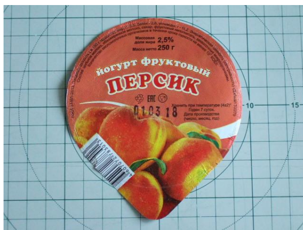
Рис. 15. Крышка-заклейка для упаковки с йогуртом из алюминиевой фольги
