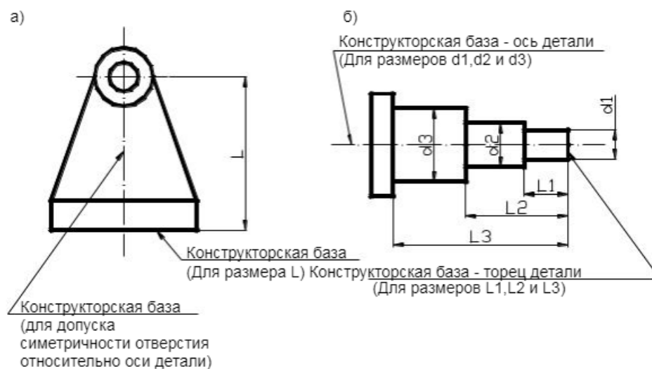
Рисунок 1. Примеры определения положения конструкторских баз для обрабатываемого сквозного отверстия (а) и ступенчатого вала (б)
