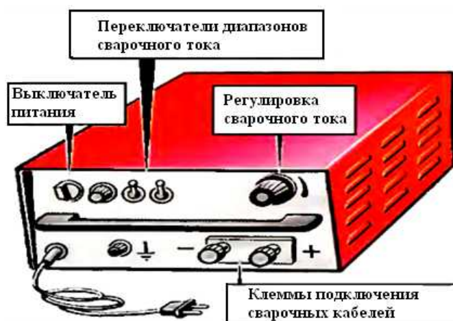
Рисунок 15. Инверторный источник питания
