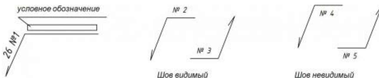
Рисунок 76. Примеры обозначения одинаковых швов на чертежах
