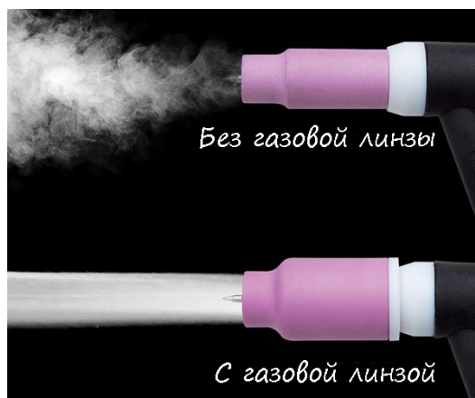
Рисунок 37. Виды движения газового потока
