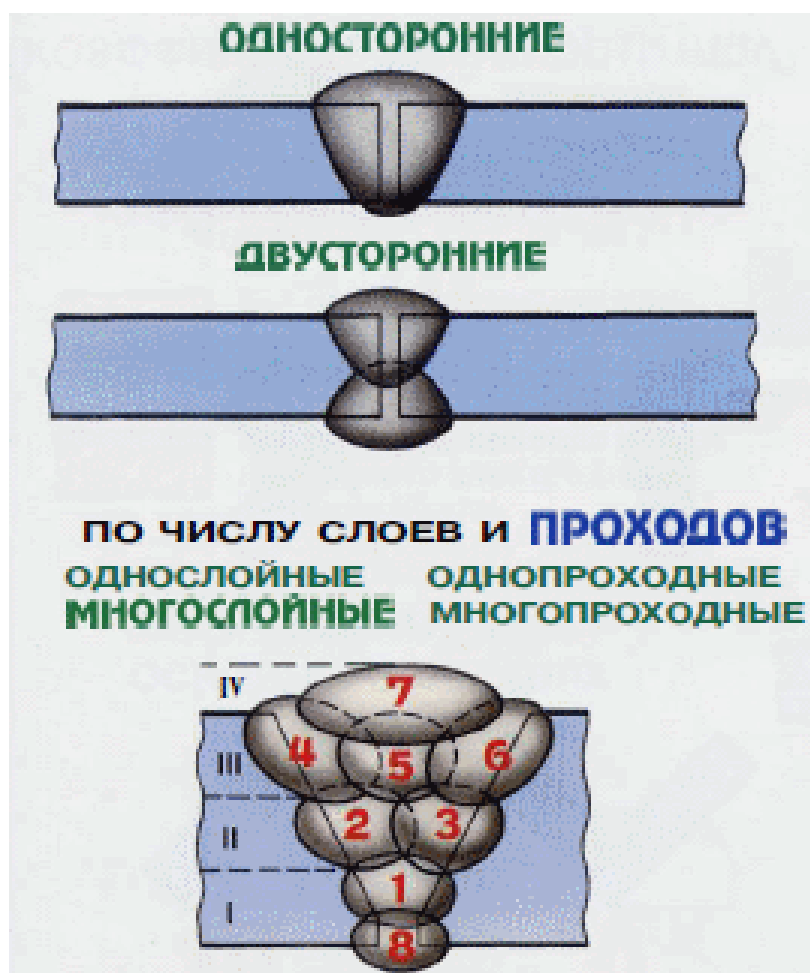
Рисунок 62. Расположение сварных швов по способу выполнения
