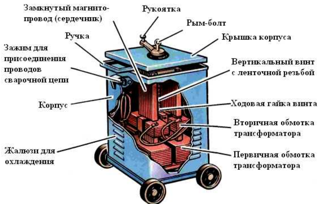
Рисунок 14. Внешний вид сварочного трансформатора
