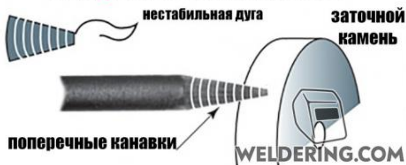
Рисунок 38. Схема заточки вольфрамового электрода
