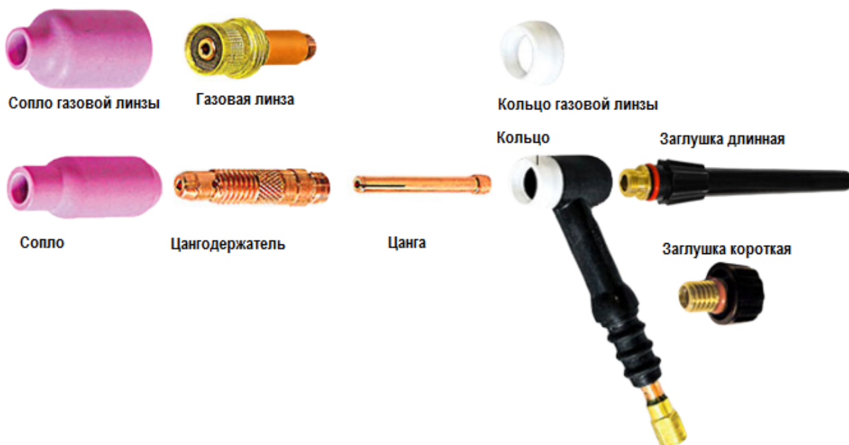
Рисунок 35. Элементы комплектации горелки TIG
