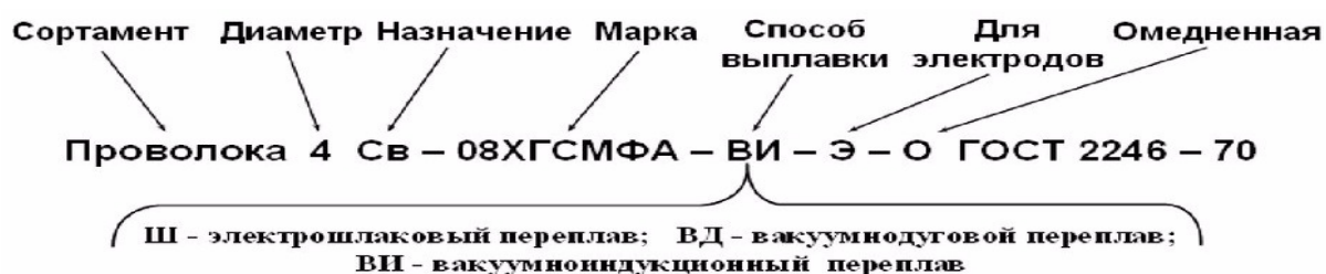
Рисунок 8. Расшифровка сварочной проволоки
