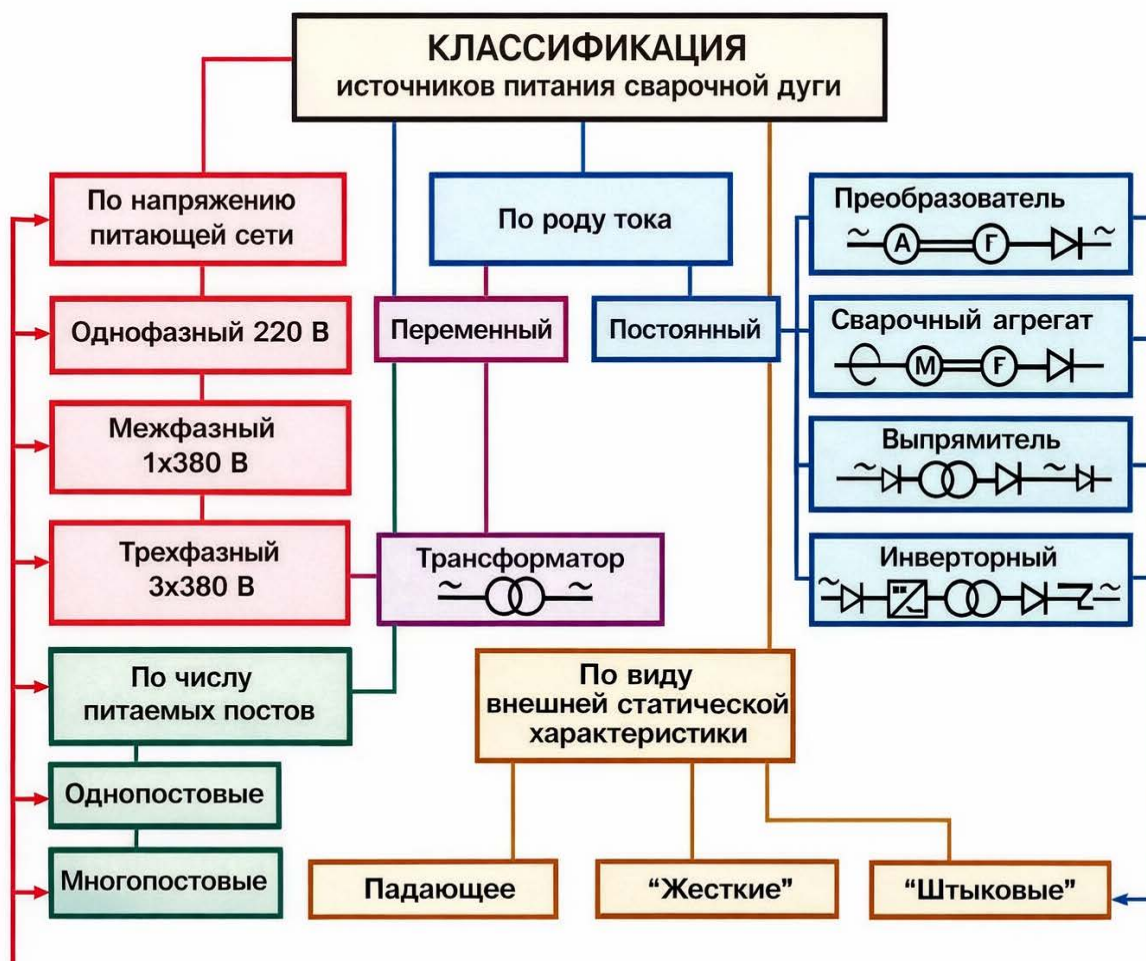
Рисунок 13. Классификация источников питания сварочной дуги
