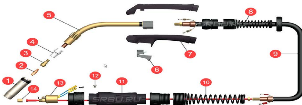
Рисунок 42. Устройство газовой горелки для полуавтомата в сборе с рукавом:
