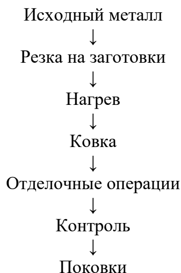
Рисунок 1. Схема технологического процессаковки поковок
