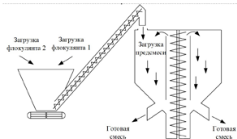
Рисунок 1. Функциональная схема дозирования и смешивания флокулянта
