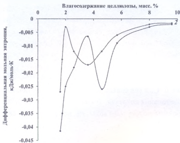
Рис. 14. Изменение дифференциальной мольной энтропии в процессе сорбции паров воды. 1 – целлюлоза, обработанная насыщенным паром ( 165\text{ }^{\circ}\text{C} , 4 мин); 2 – целлюлоза, взятая из потока во влажном состоянии
