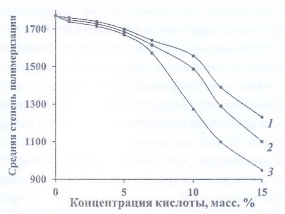
Рис. 22. Зависимость степени полимеризации от концентрации серной кислоты при продолжительности обработки 40 с (1), 60 с (2) и 300 с (3)
