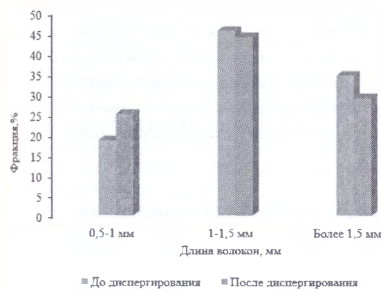
Рис. 29. Диаграмма распределения волокон целлюлозы по размерам: 1 – до диспергирования; 2 – после диспергирования
